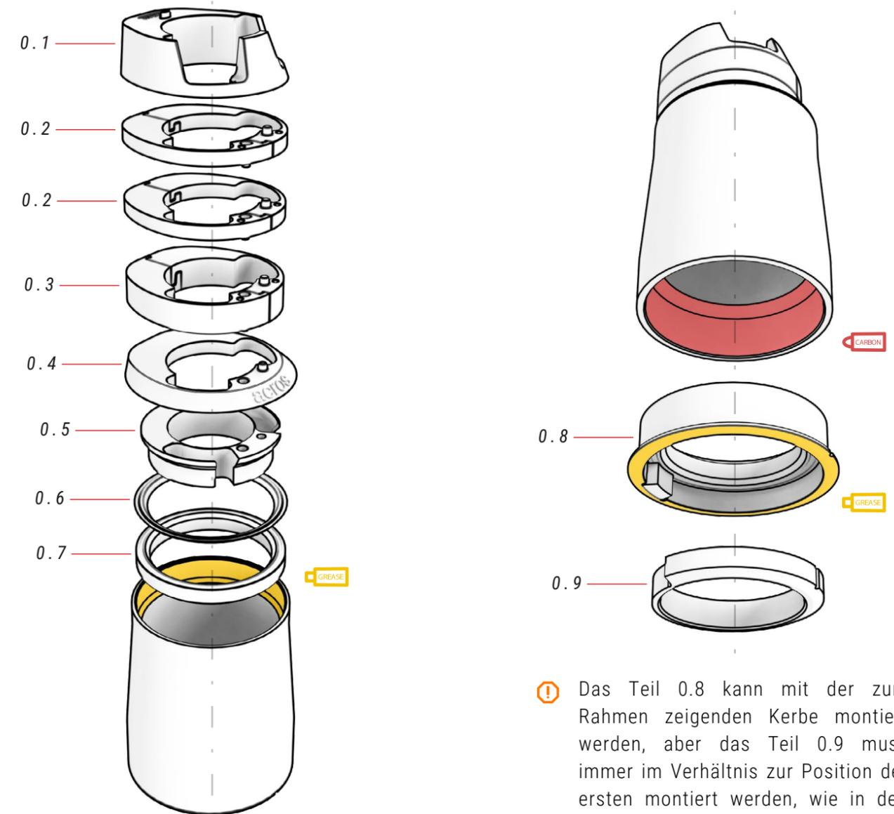
⚠ Das Teil 0.8 kann mit der zum Rahmen zeigenden Kerbe montiert werden, aber das Teil 0.9 muss immer im Verhältnis zur Position der ersten montiert werden, wie in den Abbildungen dargestellt.
